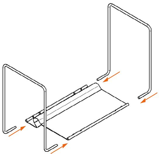
[DE] Die beiden Rohrgestelle mit der kurzen Seiten nach vorn zeigend an die Tischplatte halten und bis zum Anschlag in die Metallöffnungen schieben.
