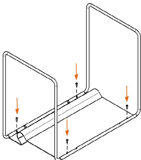
[DE] Rohrgestell mithilfe der 4 Schrauben fixieren.
