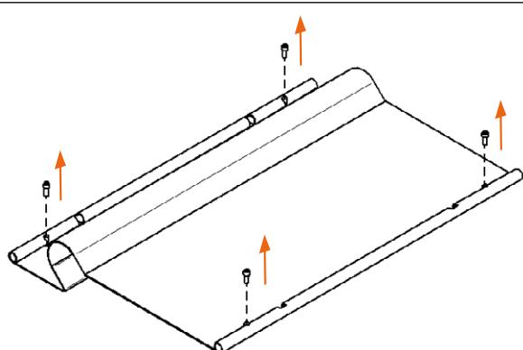
[DE] Die Tischplatte mit der Unterseite nach oben zeigend auf eine weiche Unterlage legen. Die bei der Lieferung bereits eingedrehten Schrauben mit dem beiliegenden Inbusschlüssel lösen und beiseite legen.
